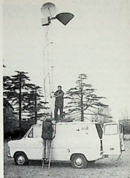
Het door de Mullard Research Laboratories ontworpen radaronderscheppingsysteem MIRANDA, gemonteerd op een bestelwagen.
